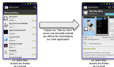
FIGURE 3.1. – Cliquer sur un élément de la liste dans la première activité permet d'ouvrir les détails dans une seconde activité
