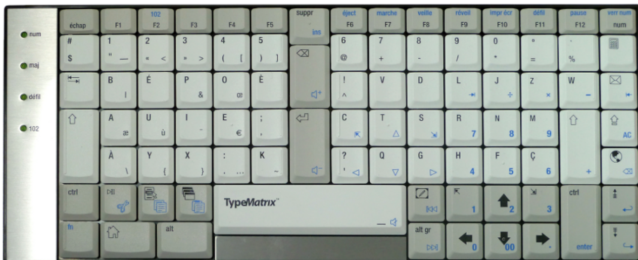
FIGURE 5. – Clavier TypeMatrix avec agencement « bépo », image empruntée à TuxFamily, tous droits réservés
